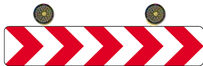
Les optiques sont placées au-dessus du signal.
